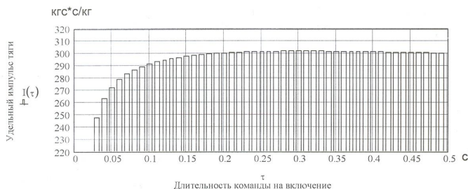
Рис. 4. Двигатели РДМТ 400А №№ 2,3,5. Зависимость удельного импульса тяги от длительности команды на включение при длительности паузы 10 с
