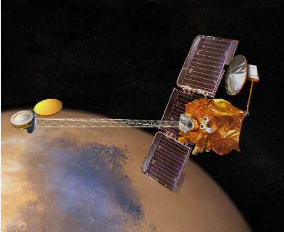
Рис. 3 Орбитальный аппарат для исследования геологического строения планеты и поиска минералов «Mars Odyssey»
