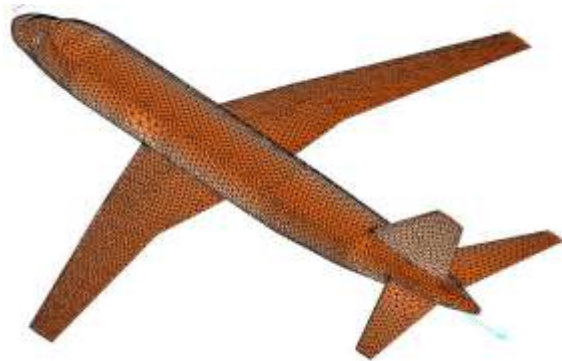
КЭ модель самолета-носителя созданная сеткопостроителем salome
