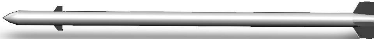
Модель УРС с передними рулями и прямыми стабилизаторами
