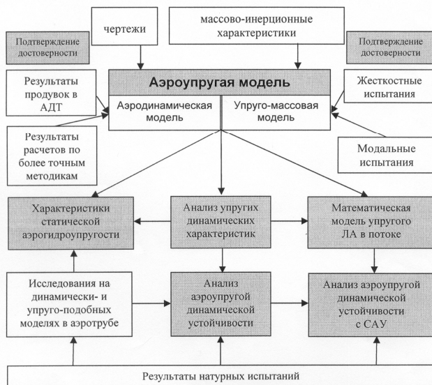
Рис. 1. Порядок подготовки и использования математической модели упругого ЛА в потоке для анализа основных проблем аэроупругости в процессе проектирования
